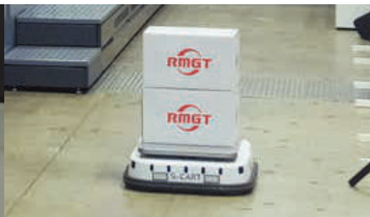
ロボットが次工程へ製品運搬
